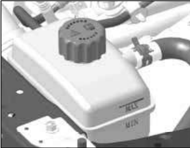
Conjunto del tanque de refrigerante secundario
