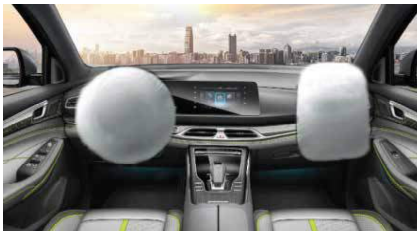
Ilustración del despliegue del airbag principal y del pasajero
